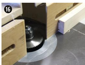
Usinage à la toupie des rainures du cadre des vitres.
