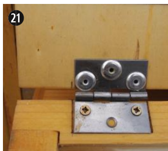
Fixation des charnières avec rivets et vis
