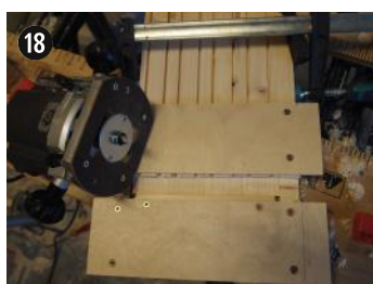
Feuillure pour montage en escargot usinée à la défonceuse avec montage d'usinage
